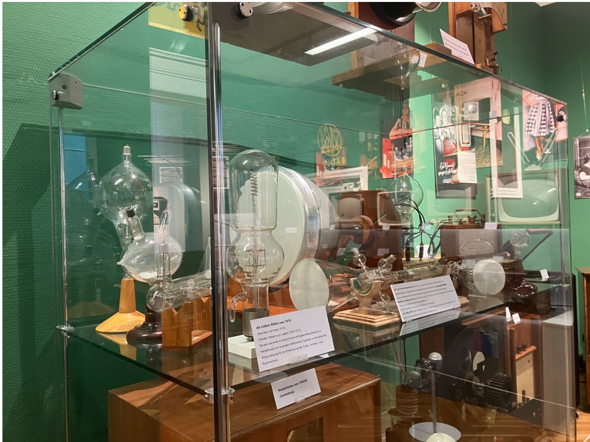
Braunsche Röhren, Grundlage elektronischer Fernsehtechnik – im Vordergrund Lieben Röhren, die ersten elektrischen Verstärkerelemente
