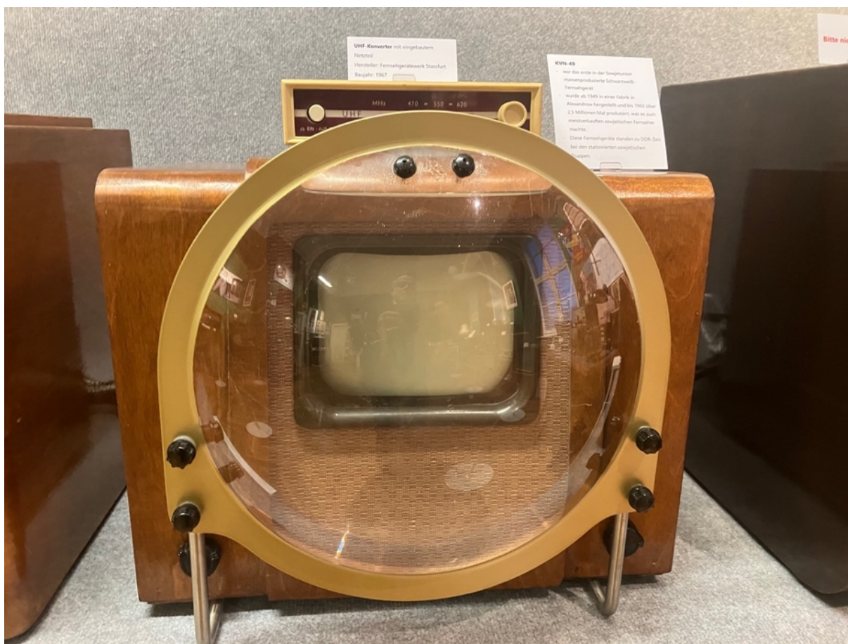
Russischer Fernseher mit Wasserlinse, oben drauf ein UHF- Konverter aus DDR- Produkti Foto: H. Manegold, Ausstellung Liesenfeld
